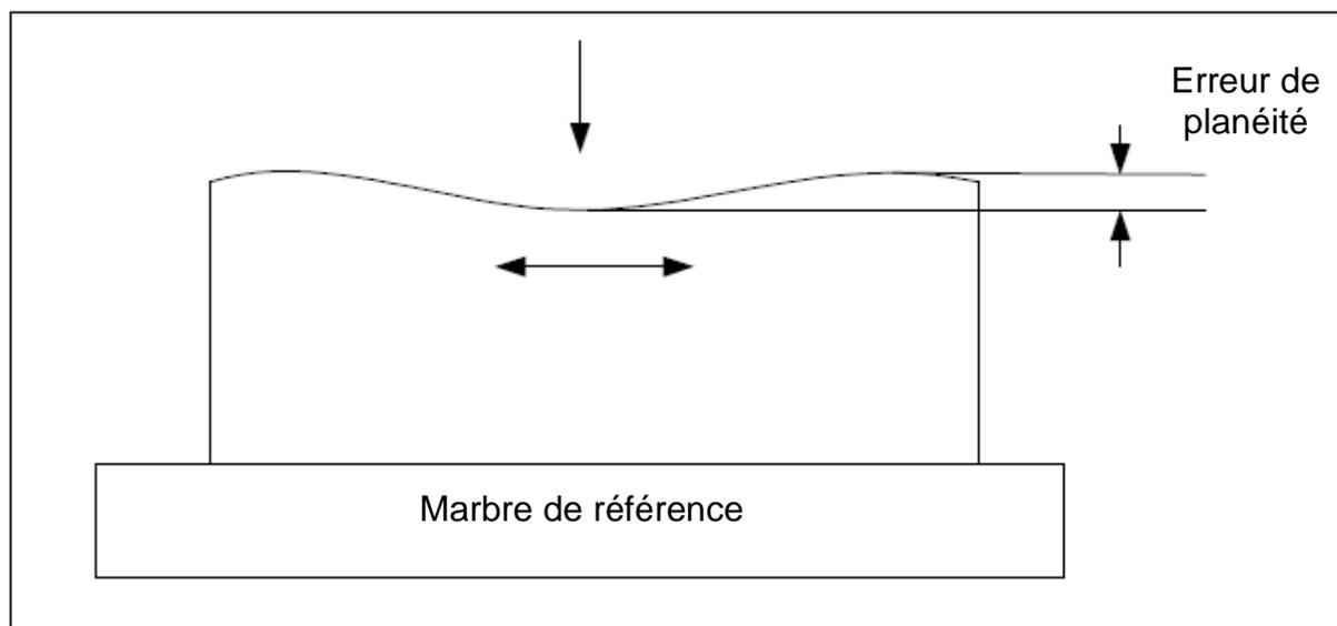
1. Serrer un palpeur cylindrique dans son support et positionner ce dernier à quelques millimètres au-dessus de la pièce.
