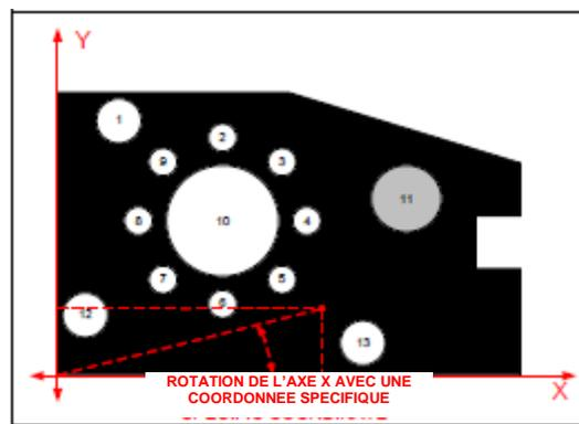
13.1.10.6. {AlgYcor}: Rotation de l'axe Y avec un angle formé par l'origine et des coordonnées saisies.
