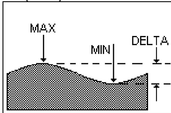
La machine continue de rafraîchir les valeurs MIN, MAX et DELTA tant que la touche {Finish} n'est pas appuyée. Lorsque la touche est pressée, les résultats sont affichés à l'écran et sont enregistrés dans la mémoire tampon. Cette fonction peut effectivement être utilisée pour aligner des pièces lourdes sur des montages.
