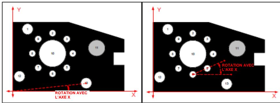
13.1.10.2 {AlignY} : Rotation de l'axe Y avec un ou deux centres sélectionnés.
