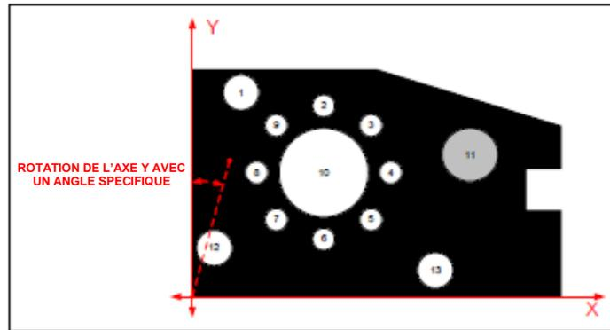
13.1.10.5. {AlgXcor}: Rotation de l'axe X avec un angle formé par l'origine et des coordonnées saisies.
