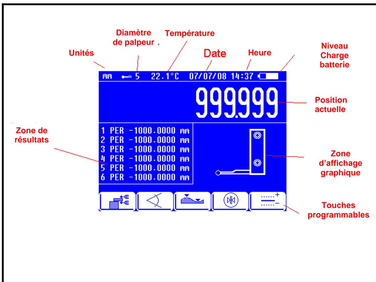
**8. Indications de la batterie :** Un symbole de batterie est affiché dans le coin supérieur droit de l'écran. Ce symbole indique l'état de la batterie. Le symbole de batterie pleine clignotera pour indiquer que la batterie est complètement chargée. Un symbole de batterie fixe indiquera la capacité actuelle de la batterie. Le tableau suivant présente ces indications avec plus de détails.
