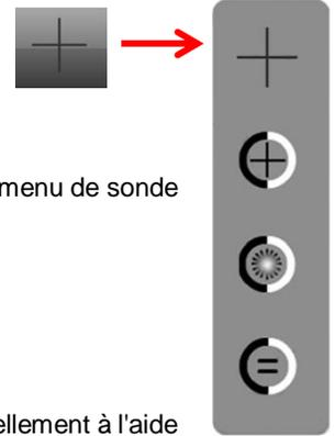
Les systèmes M2 qui prennent en charge les sondes optiques de détection des bords afficheront un menu de sonde permettant d'accéder (de haut en bas) :
