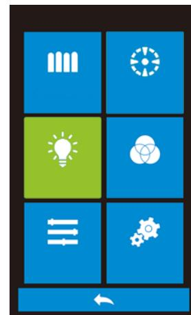
L'utilisateur règle la source lumineuse appropriée en fonction des conditions de mesure réelles. L'interface d'éclairage permet de définir l'angle d'observation standard, le type de source lumineuse standard et la source lumineuse UV (différents types d'appareils ont des configurations différentes) du système.
