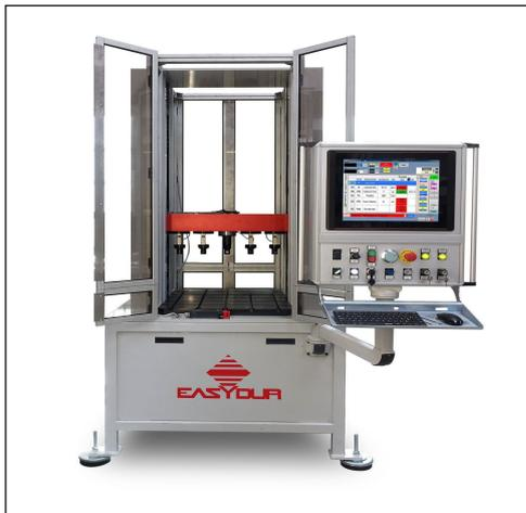
*Exemple de machine électromécanique pour essais dynamiques de fatigue et essais statiques, avec système multi-cellules et valeur max. d'échelle : 50 kN*
