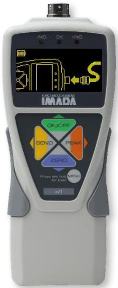
L'afficheur eZT peut être combiné à divers capteurs de charge, permettant de gérer une large plage de forces, tester des applications telles que la compression, la traction et le couple grâce à sa modularité et l'interchangeabilité des cellules connectées.
