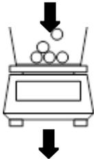
⇒ Mettre le matériau à peser sur le plateau de pesée ou dans le récipient de pesage
