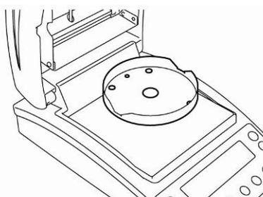
3. Mettre en place le porte-coupelles, veiller ce faisant à son positionnement correct, ◆ sur ◆.
