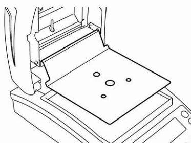
2. Adapter l'anneau de la cage de pesée, veiller ce faisant à son positionnement correct, ◆ sur ◆.
