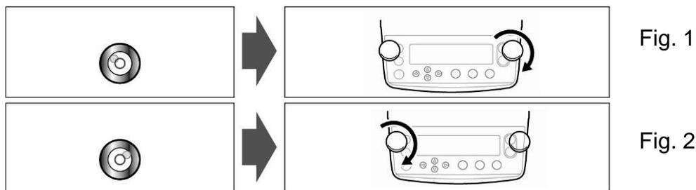
Si la bulle d'air se trouve au bord gauche, mettre à niveau sur la vis de nivellement de droite, voir sur la figure 1.
