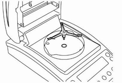
4. Mettre en place la cuvette porte-échantillon.
