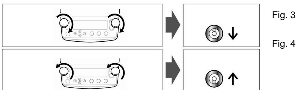
Si les deux vis de nivellement sont tournées en même temps dans le sens des aiguilles d'une montre, la bulle d'air se déplace en avant (voir sur la figure 3).
