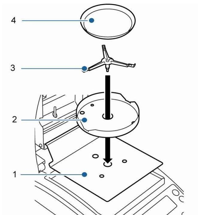
L'analyseur d'humidité est fourni à l'état décomposé en pièces détachées. Contrôler toutes les pièces immédiatement après déballage, afin de vérifier si la livraison est complète et monter les différents éléments d'assemblage comme décrit ci-après.
