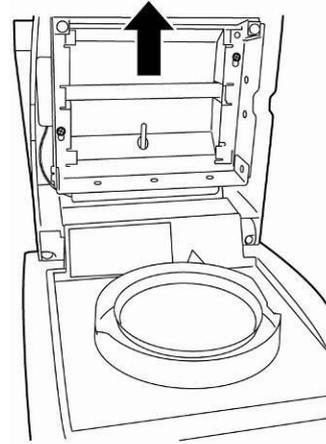
La plaque de verre [1] peut en cas de nécessité être retirée après desserrage des vis [2].
