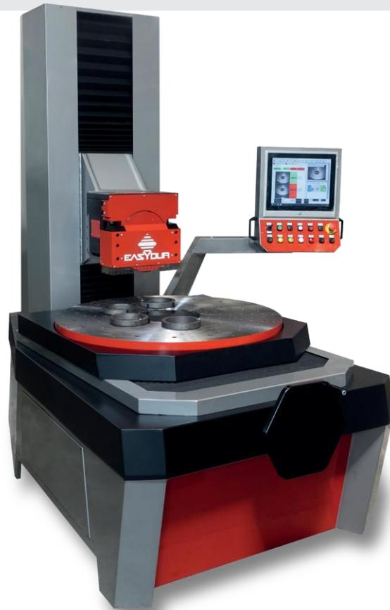
Integral Rotary a été conçu par Easysdur comme un duromètre de production et il peut être considéré comme un îlot de travail puisqu'il est équipé d'un axe de test et d'une table rotative supplémentaire ainsi que d'un deuxième axe Y pour déplacer la table rotative d'avant en arrière par rapport à la tête.
