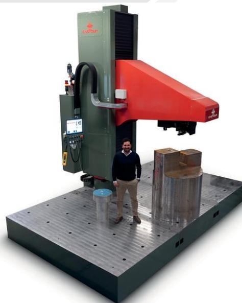
EASYFLAG 3000 est un duromètre à colonne rotative pour essais Brinell, spécialement conçu pour tester des pièces forgées de moyennes et grandes dimensions.
