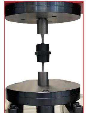
En fonction du type d'essai à effectuer, l'instrument peut être doté de différents *accessoires*: plateaux, crochets de traction pour ressorts, pinces de traction de fils et autres *équipements spéciaux* en fonction des spécifications techniques les plus diverses, requises par les standards d'essai internationaux.
