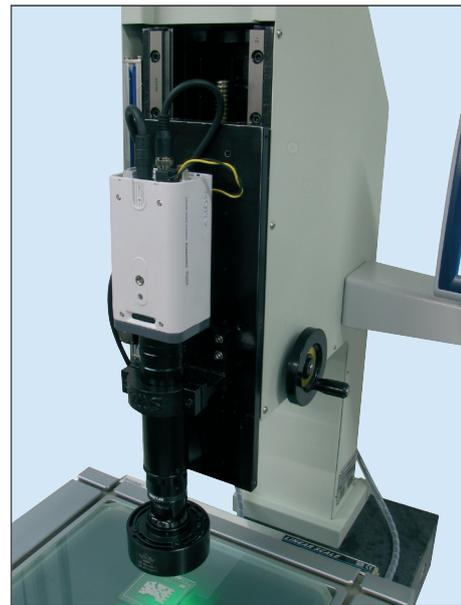
La table et la coulisse verticale sont guidées par rails largement dimensionnés. Le tout est fixé sur un marbre en granit de 100 mm d'épaisseur, assurant à l'ensemble une grande rigidité.
