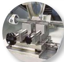
TR60 équipée d'un étau double serrage et du système de translation latérale course 136 mm
