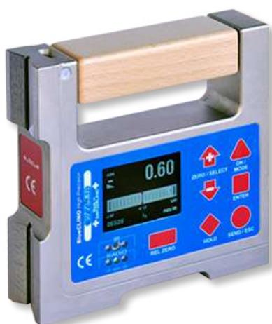
Le BlueCLINO HP (High Precision) est basé sur le BlueCLINO standard. La différence réside dans l'étendue de mesure. Le modèle HP possède une plage de  $\pm 1^\circ$ , ce qui lui permet d'avoir une meilleure précision que le modèle standard.
