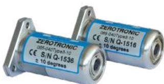
Les capteurs de la famille ZEROTRONIC possèdent un capteur d'inclinaison et une transmission de données numériques. Pour cette raison, ils offrent la possibilité de compenser les changements de température et permettent la communication de données sur de longues distances sans aucune perte.
