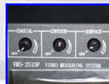
Potentiomètres sur 3 éclairages Coaxial en option
