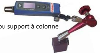
✓ Montage de la rallonge de palpeur 100 mm pour la mesure dans les alésages profonds.
