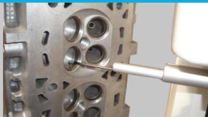
Dans un profil préalablement acquis, il est possible d'insérer des côtes et de faire coexister, profil et rugosité dans un même écran, présentant ainsi l'évaluation complète de la pièce, avec une seule mesure. Avec la fonction de comparaison auto, reconstruire sur un nouveau profil, incluant tous les paramètres et les tolérances d'une référence est chose facile. L'économie de temps est considérable lors du contrôle de pièces par lot.
