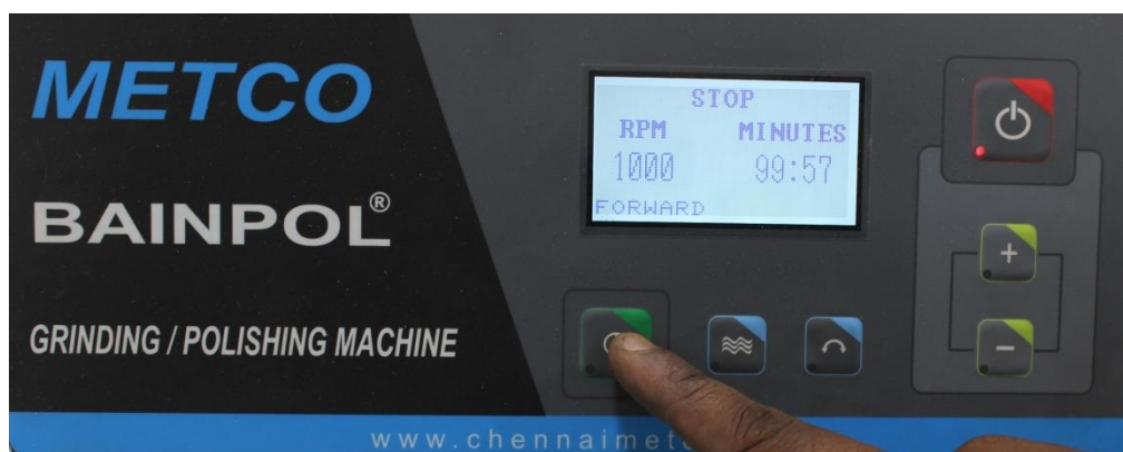
Figure 8: Bouton tactile pour démarrer / arrêter la rotation des disques
