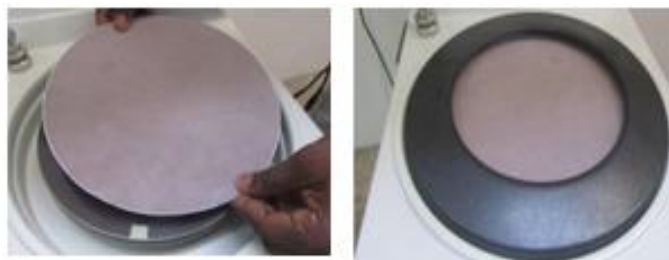
Figure 23: Méthode pour coller un tissu de polissage sur une feuille de support et la placer sur un disque magnétique
