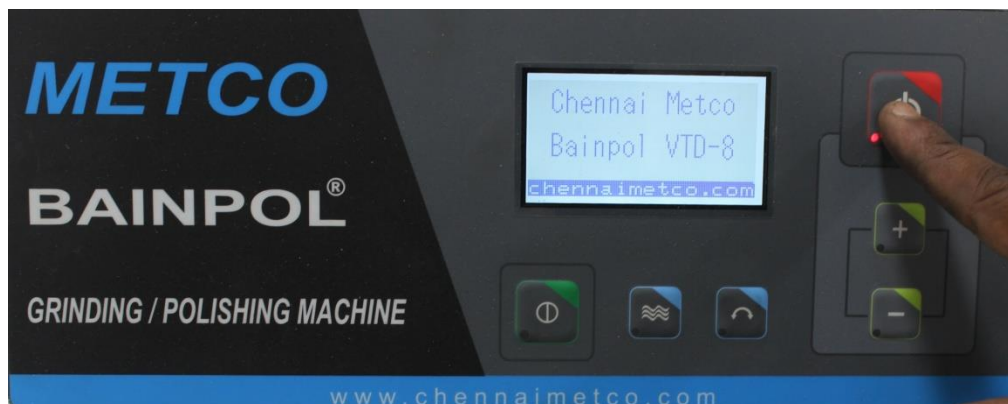
Figure 7: Bouton tactile pour allumer l'écran de la machine
