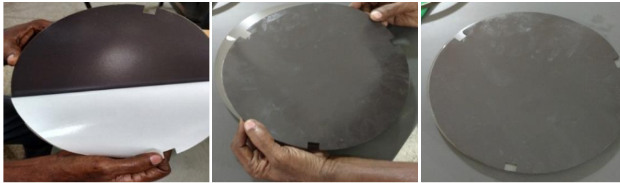
Figure 19: Méthode de collage d'un disque magnétique sur un disque en aluminium
