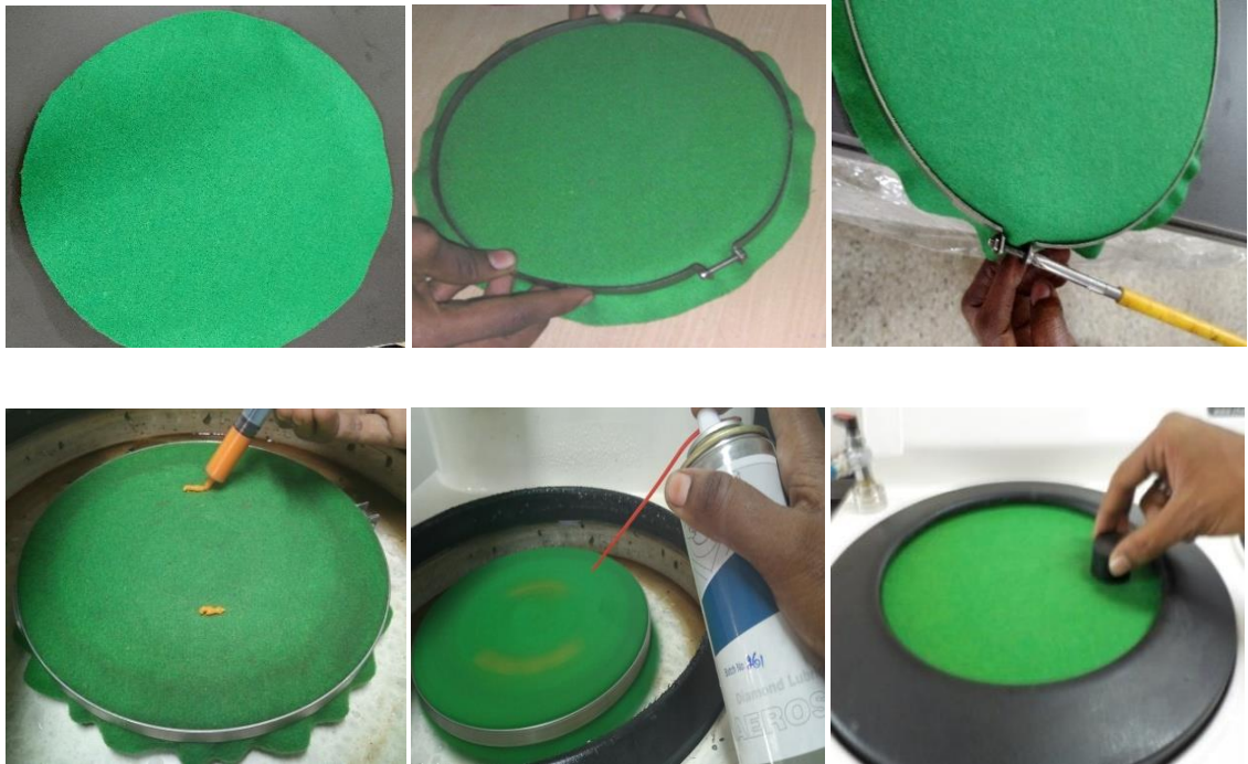
Figure 17: Procédure de polissage à l'aide d'un tissu de polissage
