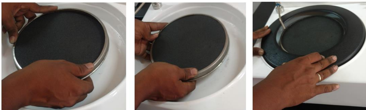
Figure 14: Procédure d'utilisation de la feuille d'émeri sans PSA
