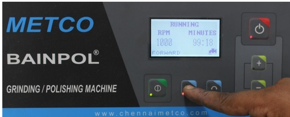
Figure 10: Bouton tactile pour activer / désactiver le débit d'eau
