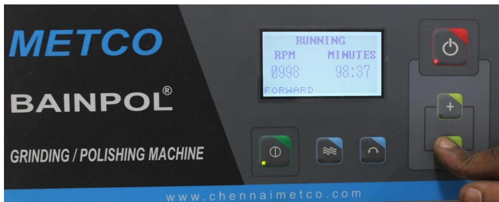
Figure 11: Bouton tactile pour augmenter / diminuer le régime de rotation du disque
