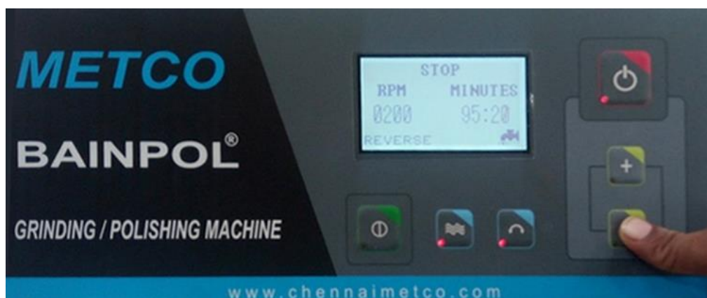
Figure 12: Bouton tactile pour augmenter / diminuer le temps en condition d'arrêt
