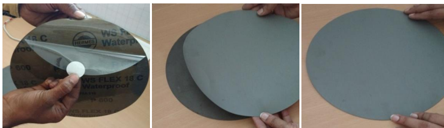
Figure 20: Méthode de collage d'une feuille abrasive sur une feuille de support
