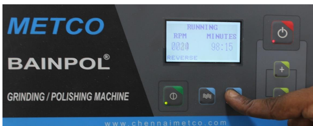
Figure 9: Bouton tactile pour la rotation avant / arrière des disques
