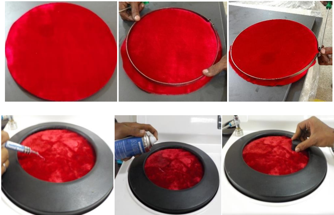
Figure 18: Procédure de polissage avec un tissu en velours
