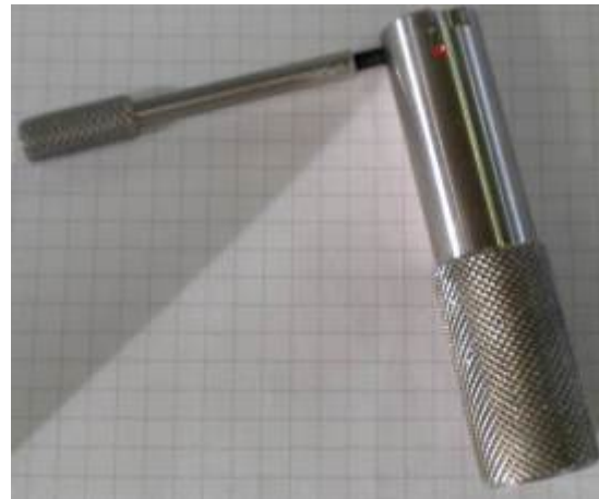
Pivot non correctement installé
