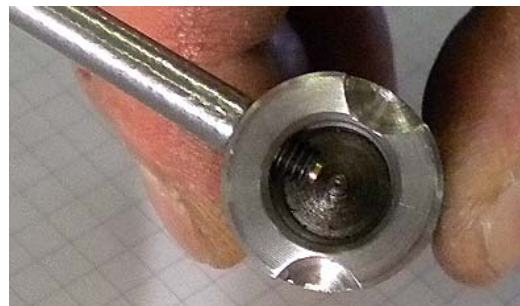
Pivot non correctement installé
