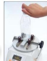
Mesure de couple, ouverture de bouteille
