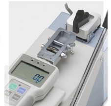
Configuration CW-500N + CH-500N sur banc d'essais horizontal
