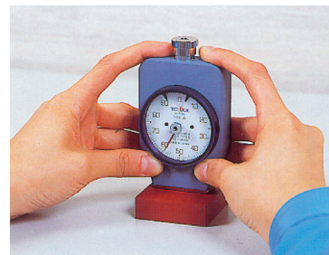
Positionnement correct des mains et du duromètre pour une mesure SHORE
