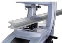
Bâti ouvert permettant de contrôler des échantillons de grandes longueurs
