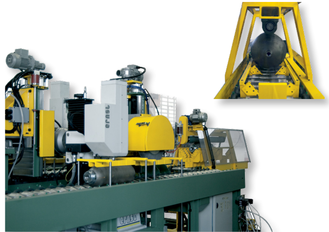
TWIN-TDM-DAL pour contrôle de bouteille, préparation de surface par polissage
