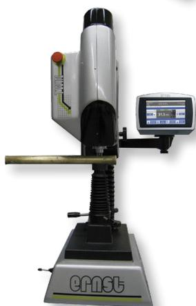
Le principe de bridage développé par ERNST permet de faire un essai sur une pièce avec un porte-à-faux important.
