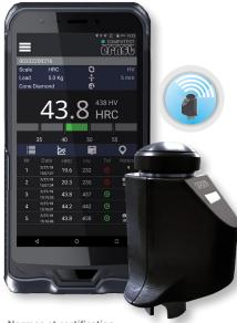
Le duromètre portable e-Computest peut-être certifié ACCREDIA [équivalent COFRAC, UKAS, DAkkS] conforme à la norme DIN-50157
