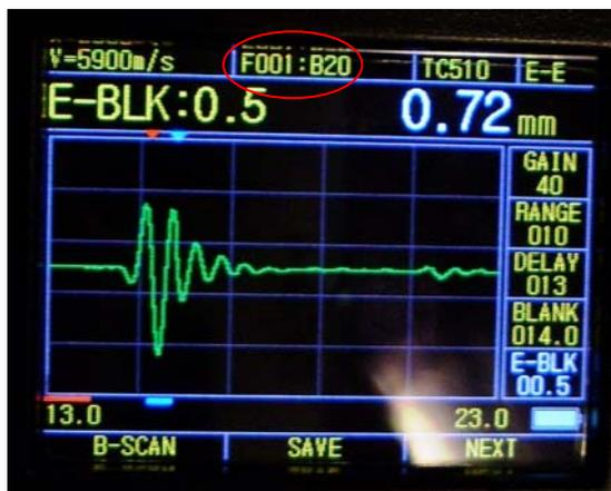
A-Scan pouvant être enregistré (SAVE) dans le tableau : **F001** en position : **B 20**
