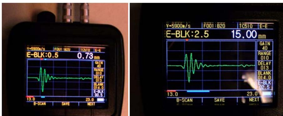
Après réglage de l' E-BLK (E-Blank) confirmation de l'épaisseur exacte du bloc étalon de 15 mm.
