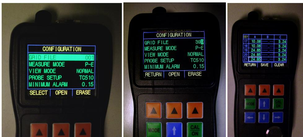
A l'aide du logiciel on peut charger (download) les mesures présentées dans le mesureur, les visualiser, obtenir des statistiques et les imprimer sous forme de rapport ; voir image ci-dessous :
