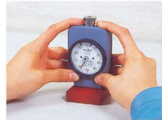
Positionnement correct des mains et du duromètre pour une mesure SHORE
