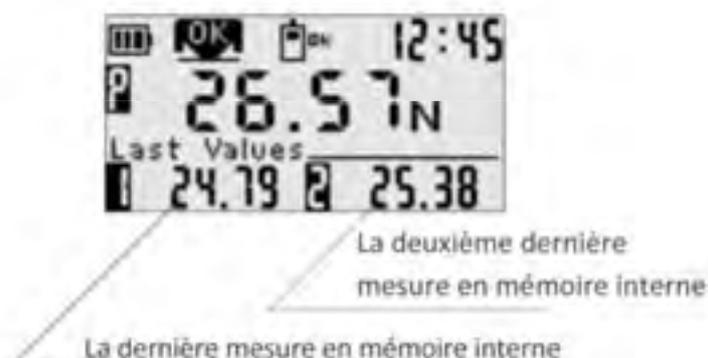
Lorsque la mesure dépasse 10% de la capacité de la jauge et chute jusqu'à moins de 7% de la capacité, la valeur maximale est transférée aux dernières valeurs.
