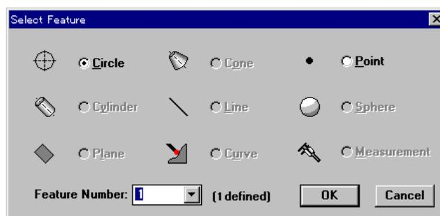
Appuyez sur 'OK' pour entrer la figure sélectionnée. L'Indicateur de Points affichera 1 point à prendre (en compte décroissant).
