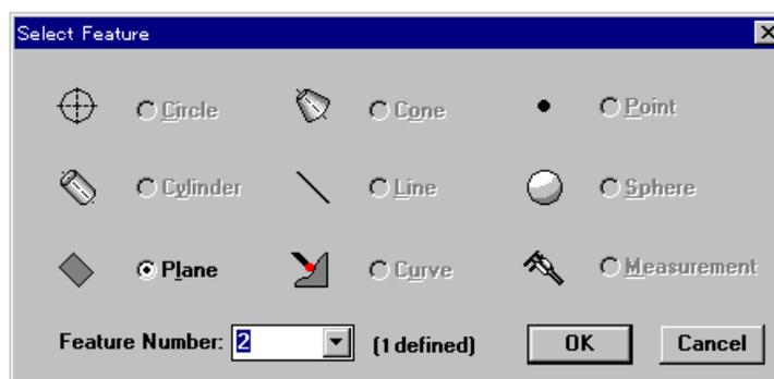
Cette boîte de dialogue permet la sélection d'une figure antérieurement définie dont on a besoin pour dégauchir. La figure par défaut sera la dernière figure définie, dans ce cas-ci Plan2. Le bouton radio du Plan est coché, et le numéro du plan sera affiché dans la fenêtre le long de Numéro de Figure. Dans ce cas, le Numéro de Figure est 2.
