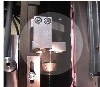
*Vue de l'écrou d'entraînement non assuré dans le bloc de déplacement de l'axe Z*
