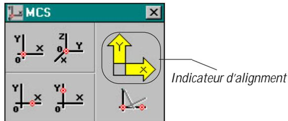
L' 'indicateur d'alignement' affiche la position de l'alignement courant. Quand vous faites tourner l'alignement en utilisant ou l'axe X ou l' axe Y, l' 'Indicateur d'alignement' va tourner avec l'alignement.
