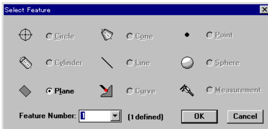
Cette boîte de dialogue permet la sélection d'une figure antérieurement définie, pour dégauchir. Dans ce cas, il s'agit de Plan1. Le bouton radio du plan est coché, et le numéro du plan sera affiché dans la fenêtre à côté du Numéro de Figure. Dans ce cas, le numéro de Figure est 1.
