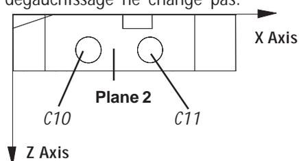
Le dernier Point de Liaison était pris au-dessus de Point5. Vu que les Cercles 10 et 11 se trouvent sur le côté de l'objet, un nouveau Point de Liaison est nécessaire, au-dessus de Plan1 et à côté de Plan2, par exemple comme dans le dessin.
