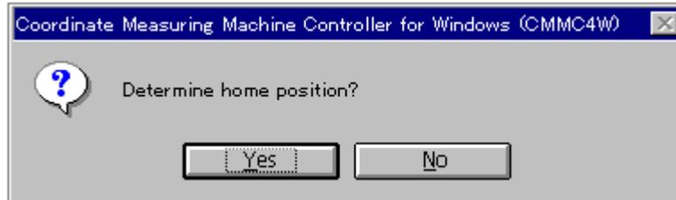
Appuyez sur 'Oui' pour établir la position d'origine dans la Position d'Origine de la DeMeet'. Attendez que la DeMeet trouve sa Position d'Origine. Ce processus prendra quelque temps, les points zéro de la machine seront cherchées à basse vitesse. Si vous appuyez sur 'Non', la position d'Origine de la DeMeet sera la position courante du palpeur (le Palpeur d'Origine de la dernière fois que la DeMeet a été utilisée).
