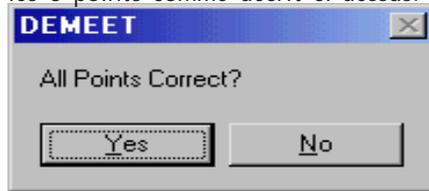
Si un mauvais point de palpation machine est pris pendant la définition du Palpeur d'Origine, le point peut être repris. Par exemple, lorsque l'Indicateur de Points affiche 3 (en compte décroissant) et on prend un mauvais point, l'Indicateur affiche 2. Pour revenir à 3, écrasez le dernier point en appuyant sur 3 sur le clavier, puis reprenez le point de palpation machine. Continuez l'opération dans la façon normale.
