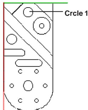
Utilisez le joystick pour déplacer le palpeur à approximativement 2 cm au-dessus du point où le Cercle 1 sera défini et appuyez sur le bouton Point de Liaison. Ce Point de Liaison sera stocké dans le Programme de Mesure.
