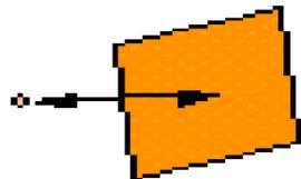
La DeMeet Palpeur calculera la distance en mesurant la distance depuis le Point à la normale du Plan au Plan.
