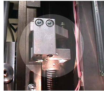
*Vue de l'écrou d'entraînement assuré dans le bloc de déplacement de l'axe Z*
