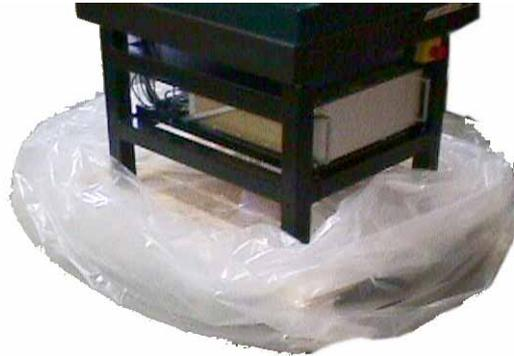
Pour la DeMeet-404/-443/-705, les panneaux latéraux verts de la DeMeet doivent être retirés avant de la soulever. Les panneaux latéraux ne sont pas montés sur la DeMeet-400.
