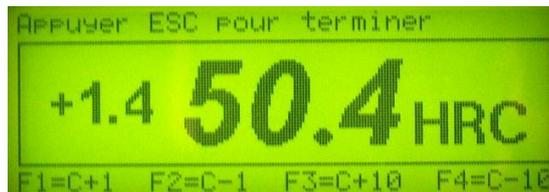
Avec les touches F1...F4 il est possible de calibrer l'instrument en ajoutant ou en enlevant une unité (ou 10) à la valeur de dureté obtenue après le dernier essai.
