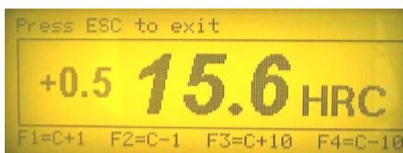
Avec les touches F1...F4 il est possible de calibrer l'instrument en ajoutant ou en enlevant une unité (ou 10) à la valeur de dureté obtenue après le dernier essai.
