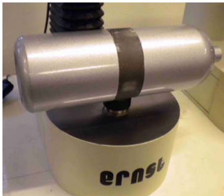
Fig. 15.7: Exemple d'essai sans vis, avec enclume
