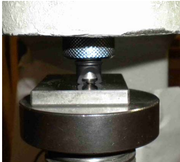
Fig. 12.3: Buse de pénétrateur en contact avec l'étalon
