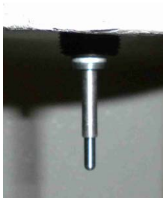
Fig. 10.5: Remontage du nouveau pénétrateur
