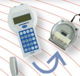
Chargement de la batterie interchangeable sur socle
