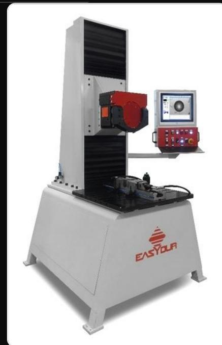
INTEGRAL REVOLVER TIRE PARTI DE LA TÊTE REVOLVER EASYDUR AVEC 8 POSITIONS QUI OFFRE SUFFISAMMENT D'ESPACE POUR LE SYSTÈME DE FRAISAGE, LE LECTEUR D'EMPREINTES ET **PLUSIEURS PÉNÉTRATEURS** POUR DES ESSAIS DANS DIFFÉRENTES ÉCHELLES
