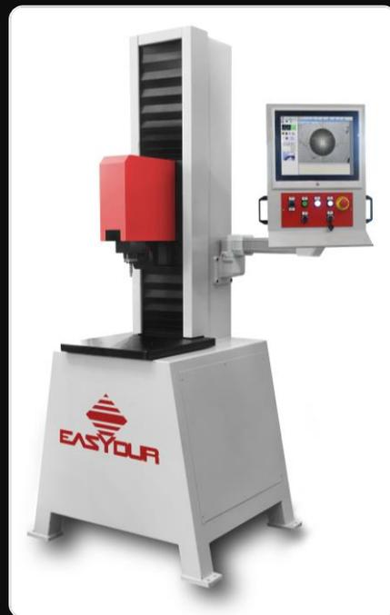
INTEGRAL UNIVERSAL EST UN TESTEUR DE DURETÉ CAPABLE D'EFFECTUER DIFFÉRENTS TESTS SELON LES RÉGLEMENTATIONS DIN-ISO ASTM DIN
