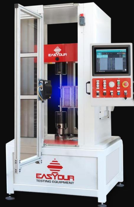
**AURA TENSILE** équipé d'un four et d'un extensomètre vidéo, complété par un mors de serrage personnalisés pour les tests à haute température
