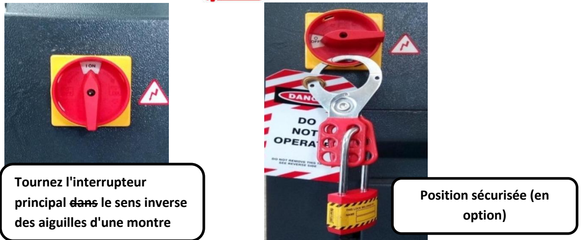
Figure 6 : Procédure de cadenassage/étiquetage (LOTO)
