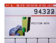
Calibration du palpeur par cycle automatique
