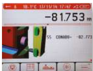
Mesure de hauteur (contact par le dessus)
