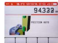
Calibration du palpeur par cycle automatique
