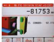
Mesure de hauteur (contact par le dessus)
