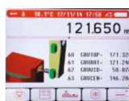
Mesure du diamètre d'un alésage
